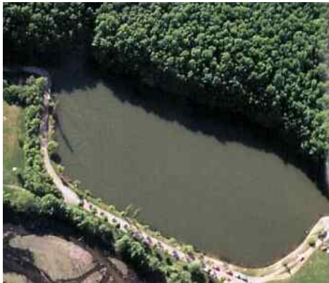
Abbildung 24: Mit Bergematerial nachträglich aufgefüllter Absinkweiher (Netzbachtal, Saarland) /ASV, 2004/
