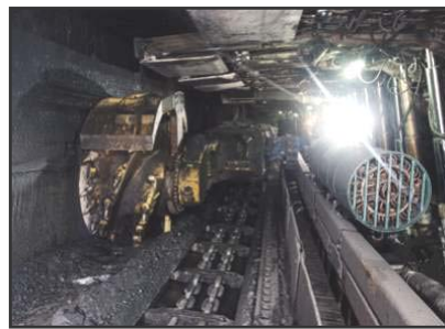
Abbildung 7: Klimatisierung untertage (links: Sonderbewetterung rechts: Strebkühler)
