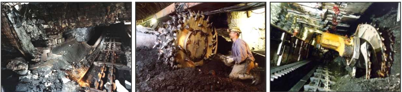
Abbildung 5: Mechanisierung beim Steinkohle-Abbau: Kohlenhobel (links) – bereits seit 1943 auf Ruhrzechen im Einsatz - und Walzenschrämlader rechts); zur Staubstromlenkung und Staubbeseitigung ist der Schneidkopf des Walzenschrämladers mit Wasserdüsen ausgerüstet (mitte) /DSK, 04/
